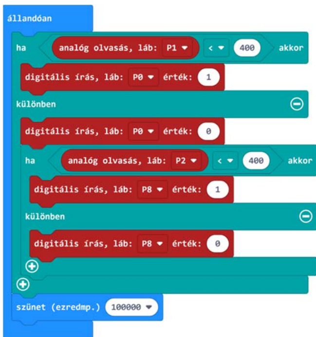
11. ábra: Az öntözőberendezés programja
