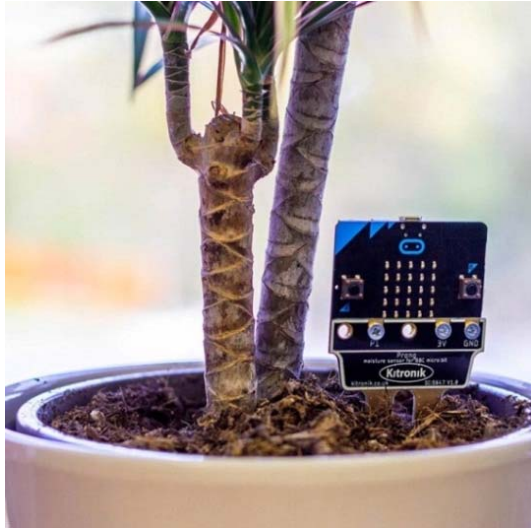
7. ábra: Virágföldek nedvességtartalmának mérése
